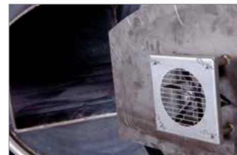
Ventilátor ve dveřích pece /
